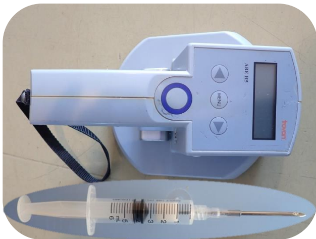
写真1 針の中にチップが入っています 上の機械で読み取ります
